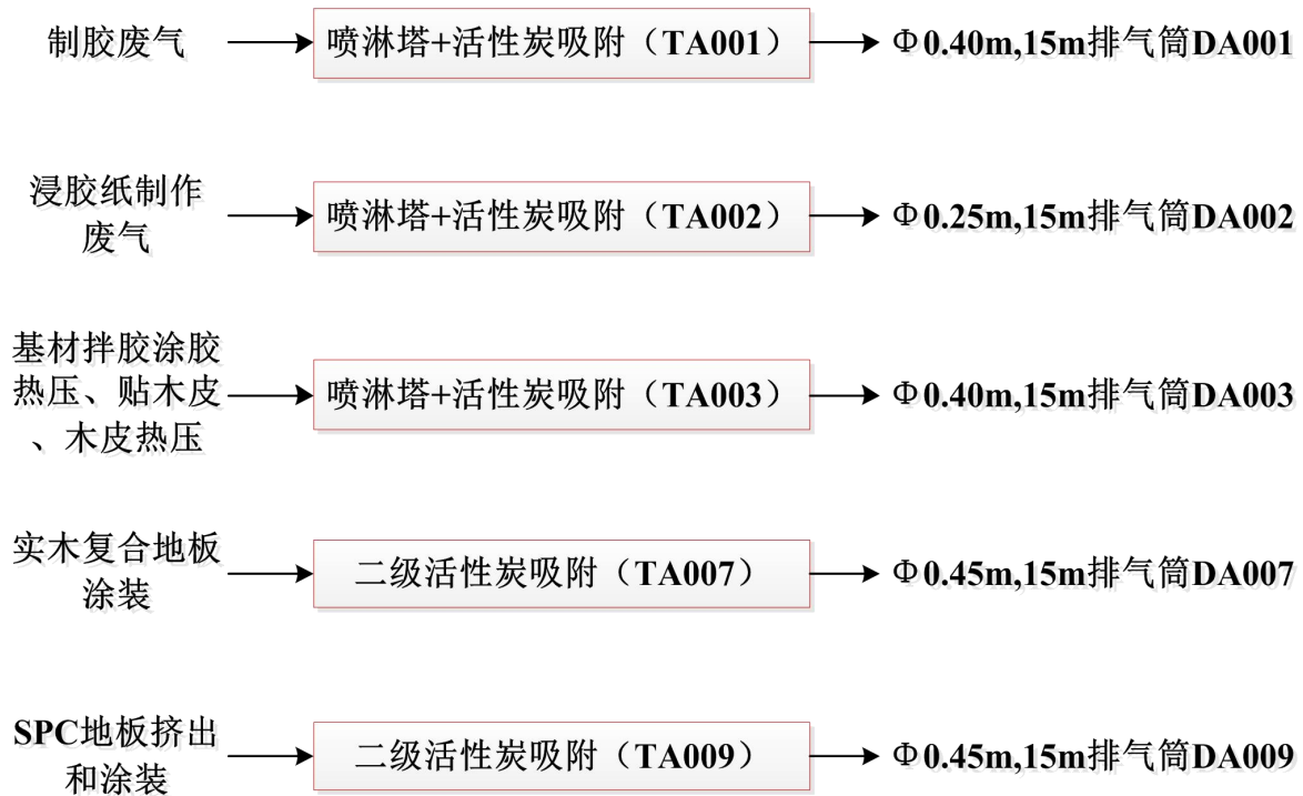
图 7.2.1-2 项目有机废气处理工艺流程
