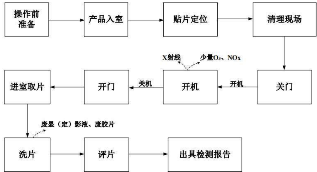
图 9-5 探伤室探伤工作流程及产污环节示意图
