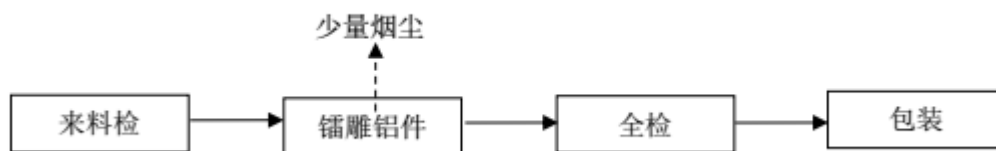
图 2.1-14 镭雕生产工艺流程及排污节点图
