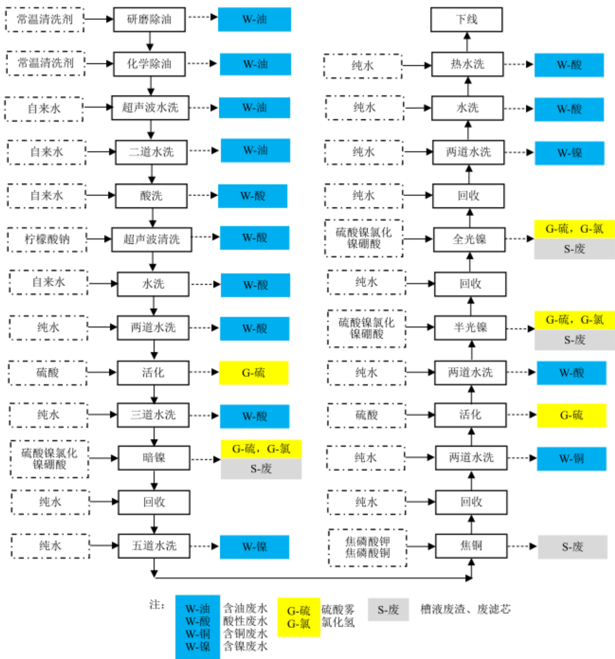
图 3.3.5-1 已建钹铁硼镀镍线工艺流程及产污节点
