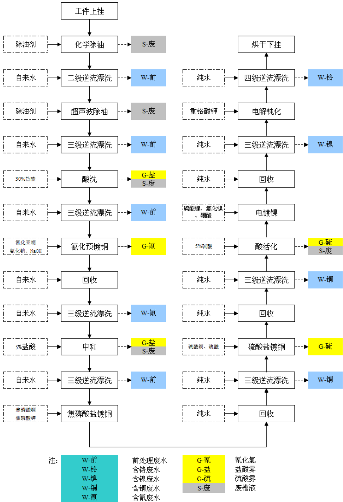
图 3.1.7-7 已批复电镀镍线工艺流程及产污节点图
