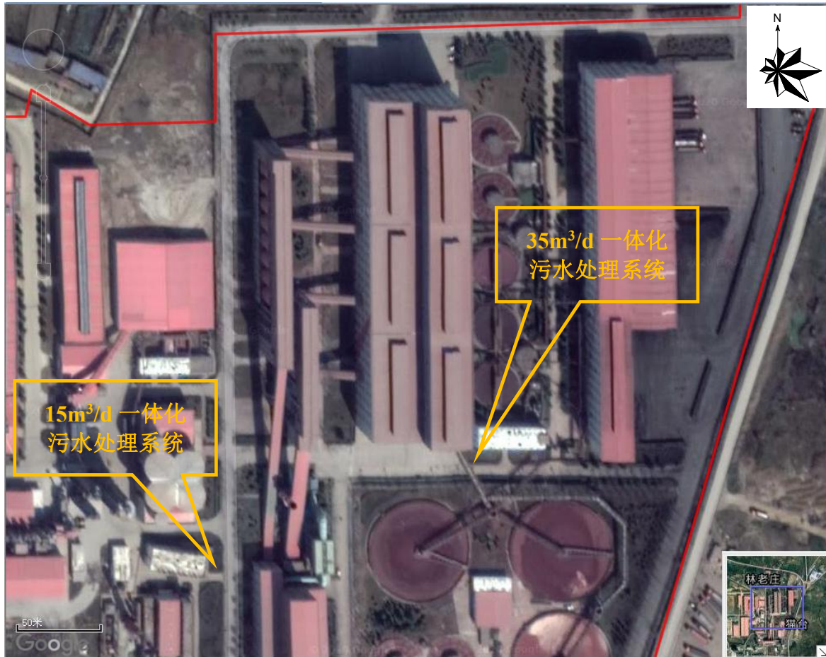
图 3.4-2 新增两处一体化污水处理设施位置示意图
