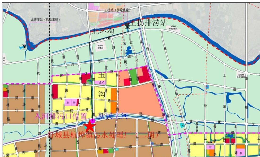
图 4.2-3 污水处理厂尾水排水路径图
