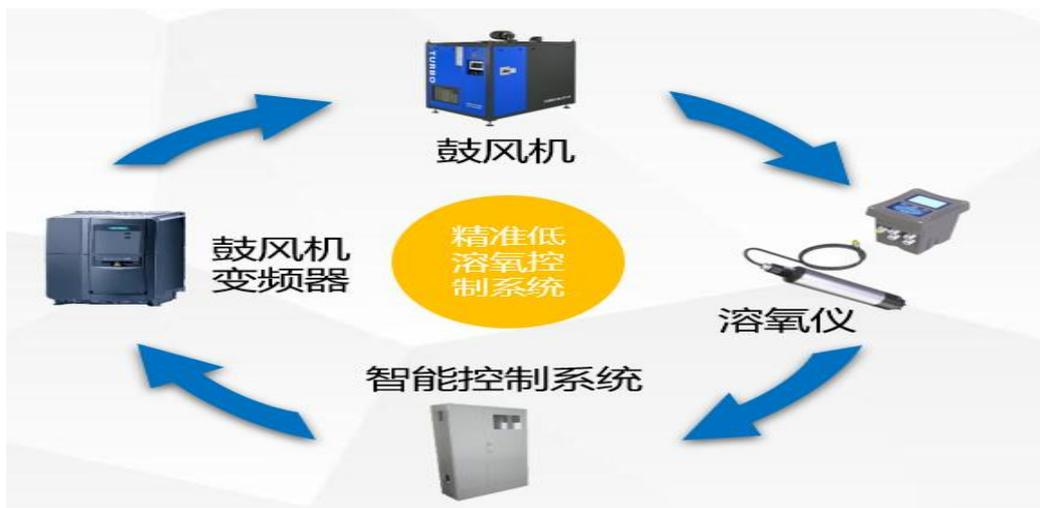
图 7.2-14 新型溶氧精确控制系统原理图
